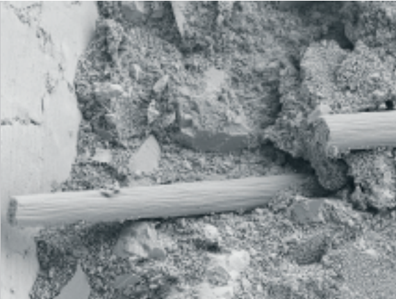
Photo microscopique qui montre l'incorporation nanocristalline d'une fibre de carbone dans CarboNit. A gauche, comparaison de la résistance à la traction d'une fibre de carbone à celle du titane.
